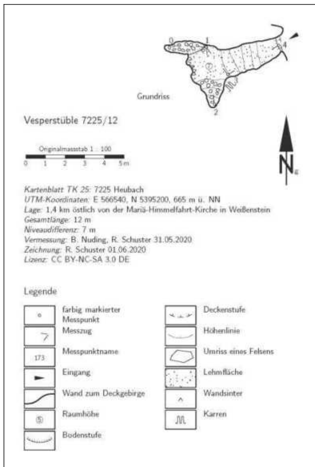
Abb. 4 und 5: Plan der Höhle Vesperstüble in Grundriss und Längsschnitt (Zeichnung Roger Schuster, 2020). Aufnahmemaßstab 1:100.
