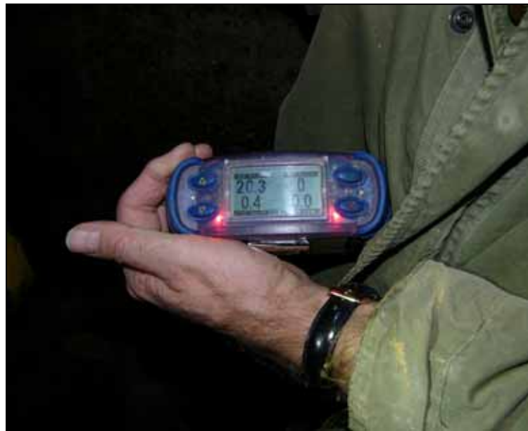
Abb. 4: Das Gasmessgerät, das die Forscher während der Befahrung des Stollens bei sich trugen.
